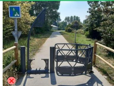
Dispositif anti-intrusion inadapté, excluant les vélos cargo, les carioles et décourage de façon générale les cyclistes
