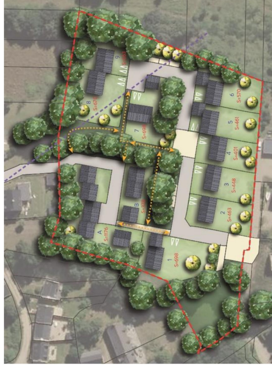
Illustration d'une trame viaire mixte et adaptée aux usages mixte d'un nouveau quartier
